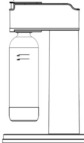
步驟六、充氣完成後，將水瓶逆時針旋轉取下，即可分杯飲用氣泡水
